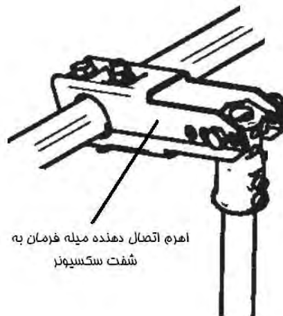
شکل (۱۱): اهرم اتصال دهنده لوله فرمان به شفت سکسیونر
