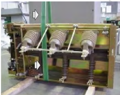
شکل (۱۳): نحوه حمل سکسیونر قابل قطع زیر بار به وسیله جرثقیل سقفی
